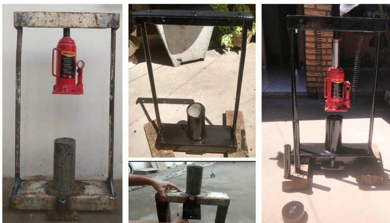
**Figura 9:** Prensa hidráulica desenvolvida para o estudo
