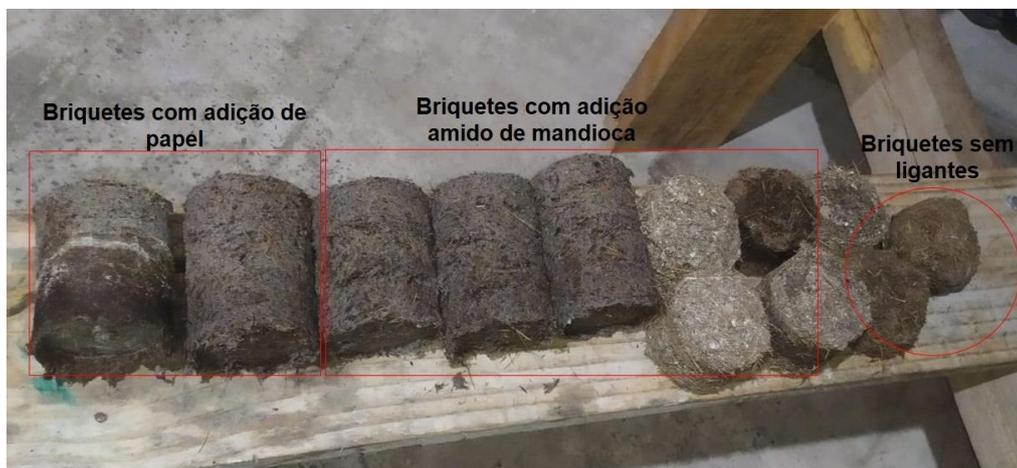
**Figura 11:** Comparação entre os briquetes produzidos
