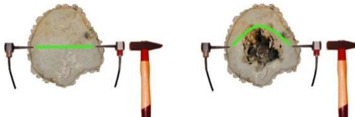
Figura 2- Esquema de captação do som por tomógrafo
